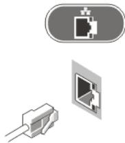
**Figure 9. Connexion réseau**
